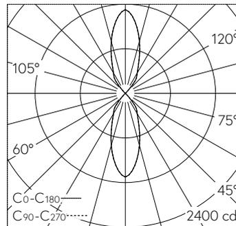
LED 3000 K 19.3 W 1806 lm-h / CIE Flux 96 100 100 50 100 / C84 selon DIN 5040
