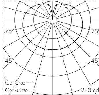
LED 3000 K 12 W 1268 lm-h / CIE Flux 25 50 75 56 100 / C12 selon DIN 5040
