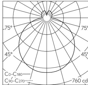
LED 3000 K 29 W 2465 lm-h / CIE Flux 43 73 91 83 100 / B32 selon DIN 5040
