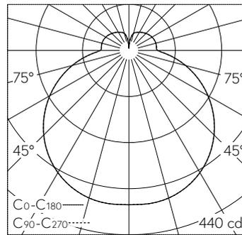
LED 3000 K 19.1 W 1770 lm-h / CIE Flux 39 68 88 79 100 / B32 selon DIN 5040
