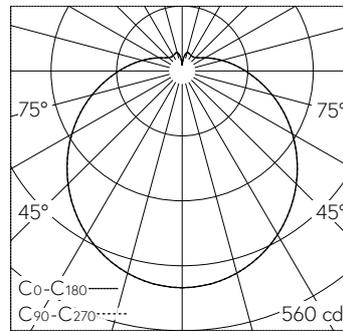
LED 2700 K 24.6 W 2188 lm-h / CIE Flux 37 65 85 81 100 / B31 selon DIN 5040
