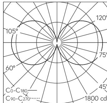
LED 4000 K 115 W 12945 lm-h / CIE Flux 13 38 67 50 100 / C11 selon DIN 5040
