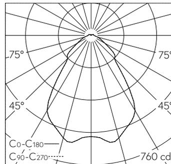
LED 4000 K 13.4 W 1195 lm-h / CIE Flux 66 88 96 95 100 / A61 selon DIN 5040
