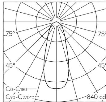
LED 3000 K 10.4 W 604 lm-h / CIE Flux 69 89 98 98 100 / A62 selon DIN 5040
