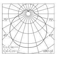
LED 2700 K 33.5 W 2730 lm-h / CIE Flux 39 68 88 79 100 / B32 selon DIN 5040
