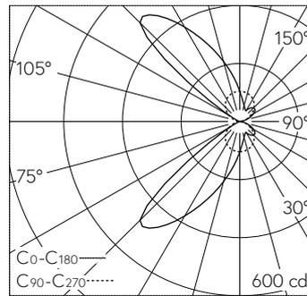
LED 3000 K 29 W 1067 lm-h / CIE Flux 44 86 98 50 100 / C44 selon DIN 5040
