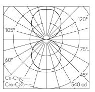
LED 3000 K 26.7 W 1948 lm-h / CIE Flux 47 79 95 50 100 / C43 selon DIN 5040
