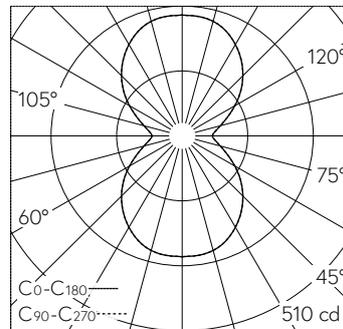
LED 3000 K 26.7 W 2164 lm-h / CIE Flux 41 69 87 50 100 / C33 selon DIN 5040
