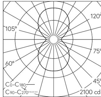
LED 3000 K 48 W 7701 lm-h / CIE Flux 41 70 87 50 100 / C33 selon DIN 5040
