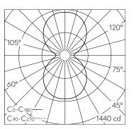
LED 3000 K 30 W 5979 lm-h / CIE Flux 42 71 89 50 100 / C33 selon DIN 5040
