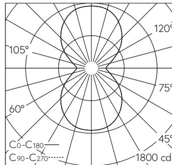
LED 3000 K 48 W 7610 lm-h / CIE Flux 41 70 87 50 100 / C33 selon DIN 5040
