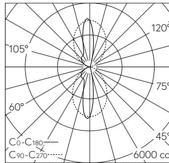
LED 3000 K 53.7 W 5658 lm-h / CIE Flux 63 87 98 50 100 / C54 selon DIN 5040
