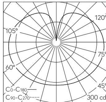
LED 4000 K 26.5 W 2670 lm-h / CIE Flux 24 49 74 54 100 / C12 selon DIN 5040
