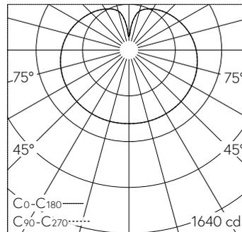
LED 3000 K 65 W 7154 lm-h / CIE Flux 26 51 75 56 100 / C22 selon DIN 5040
