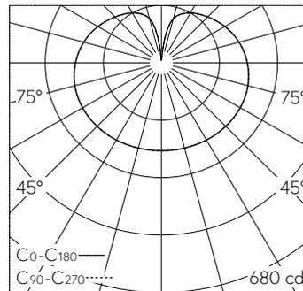
LED 4000 K 26.5 W 2955 lm-h / CIE Flux 25 50 75 56 100 / C12 selon DIN 5040
