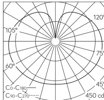
LED 4000 K 39.5 W 4086 lm-h / CIE Flux 24 49 74 54 100 / C12 selon DIN 5040
