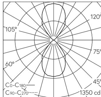
LED 3000 K 240 W 25680 lm-h / CIE Flux 85 99 100 50 100 / C84 selon DIN 5040
