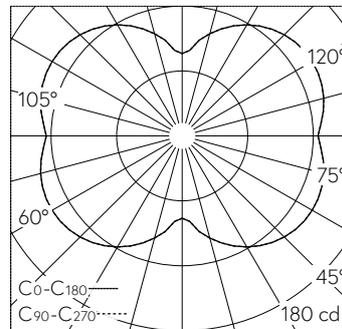
LED 4000 K 240 W 19380 lm-h / CIE Flux 22 48 74 50 100 / C12 selon DIN 5040
