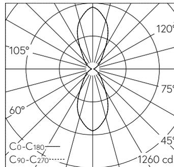
LED 4000 K 120 W 10445 lm-h / CIE Flux 71 90 97 50 100 / C64 selon DIN 5040
