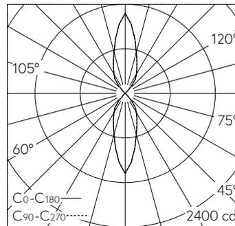
LED 3000 K 120 W 9684 lm-h / CIE Flux 94 99 100 50 100 / C84 selon DIN 5040
