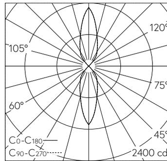
LED 3000 K 240 W 20664 lm-h / CIE Flux 93 99 100 50 100 / C84 selon DIN 5040
