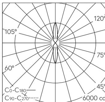
LED 3000 K 120 W 10980 lm-h / CIE Flux 93 98 100 50 100 / C84 selon DIN 5040
