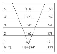
LED 3000 K 13.5 W 1029 lm-h 44° / CIE Flux 0 0 0 0 100 / E84 selon DIN 5040
