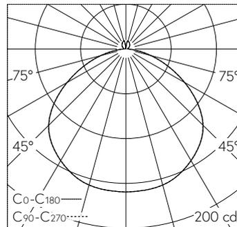
LED 4000 K 7.3 W 515 lm-h / CIE Flux 47 80 96 94 100 / A43 selon DIN 5040
