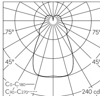
LED 3000 K 7.3 W 545 lm-h / CIE Flux 51 73 88 73 100 / B42 selon DIN 5040
