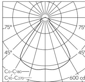
LED 3000 K 18.2 W 792 lm-h / CIE Flux 79 90 98 99 100 / A74 selon DIN 5040
