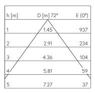
LED 3000 K 28.8 W 1351 lm-h 72° / CIE Flux 83 93 99 100 100 / A70 selon DIN 5040
