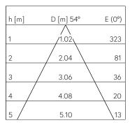
LED 3000 K 13 W 330 lm-h 54° / CIE Flux 78 92 97 100 100 / A70 selon DIN 5040
