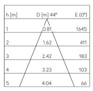
LED 3000 K 13.7 W 1096 lm-h 44° / CIE Flux 94 100 100 100 / A80 selon DIN 5...
