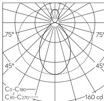
LED 3000 K 16.3 W 460 lm-h / CIE Flux 41 67 85 69 100 / B32 selon DIN 5040
