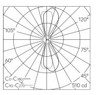
LED 3000 K 19.5 W 443 lm-h / CIE Flux 74 89 96 50 100 / C64 selon DIN 5040
