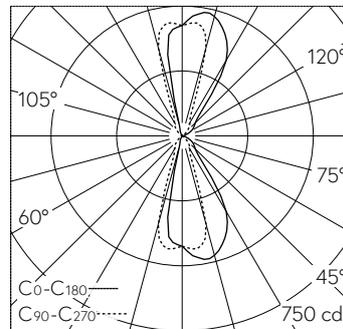
LED 3000 K 28 W 567 lm-h / CIE Flux 82 95 99 50 100 / C74 selon DIN 5040
