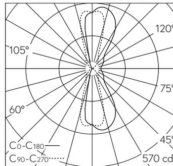
LED 3000 K 19.5 W 640 lm-h / CIE Flux 64 81 92 50 100 / C53 selon DIN 5040
