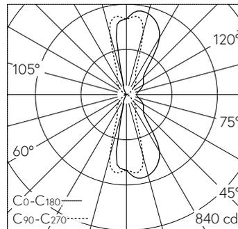
LED 3000 K 28 W 962 lm-h / CIE Flux 63 82 92 50 100 / C53 selon DIN 5040
