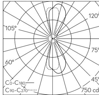
LED 3000 K 28 W 642 lm-h / CIE Flux 74 90 97 50 100 / C64 selon DIN 5040
