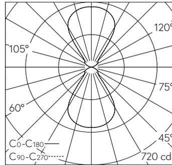
LED 3000 K 28 W 1291 lm-h / CIE Flux 76 91 99 50 100 / C64 selon DIN 5040
