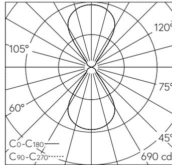
LED 3000 K 28 W 1120 lm-h / CIE Flux 83 94 99 50 100 / C74 selon DIN 5040
