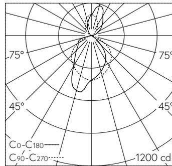
LED 3000 K 19.5 W 1315 lm-h / CIE Flux 53 83 96 74 100 / B43 selon DIN 5040
