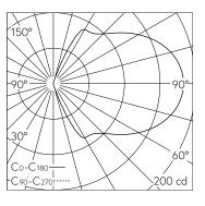
LED 3000 K 28.4 W 448 lm-h / CIE Flux 11 35 65 50 100 / C11 selon DIN 5040
