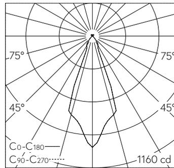
LED 3000 K 18 W 470 lm-h / CIE Flux 95 100 100 88 100 / B83 selon DIN 5040
