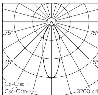
LED 3000 K 16 W 1460 lm-h / CIE Flux 82 89 96 97 100 / A71 selon DIN 5040
