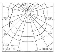
LED 3000 K 19.8 W 2199 lm-h / CIE Flux 30 57 80 61 100 / B21 selon DIN 5040
