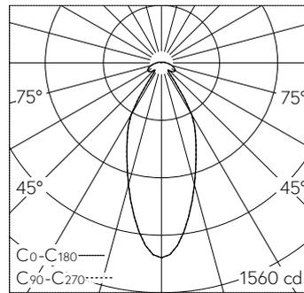
LED 3000 K 10.6 W 1142 lm-h / CIE Flux 66 80 93 95 100 / A51 selon DIN 5040
