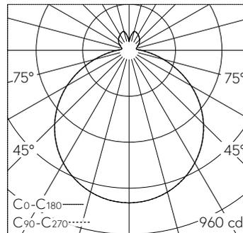
LED 4000 K 28.7 W 2820 lm-h / CIE Flux 45 75 92 86 100 / B43 selon DIN 5040
