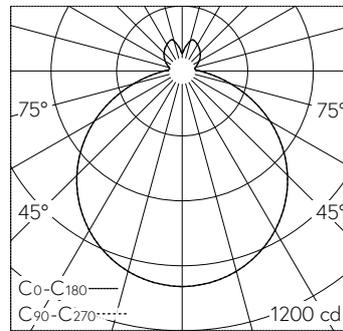
LED 3000 K 35 W 3640 lm-h / CIE Flux 45 75 92 84 100 / B43 selon DIN 5040
