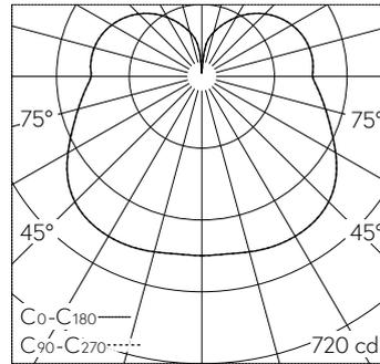
LED 3000 K 39.3 W 3866 lm-h / CIE Flux 30 58 80 62 100 / B21 selon DIN 5040
